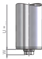
UB: Rohrboden mit Ablassschraube G
