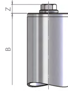
BC: Rohrboden mit Entlüftungsschraube G
