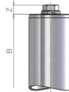
BC: Rohrboden mit Entlüftungsschraube G
